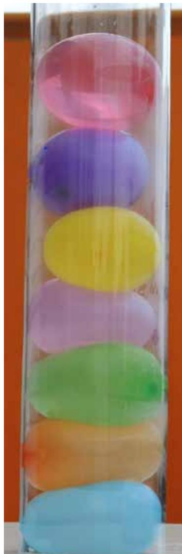
Durch die **Schwerkraft** verändert sich die Kraft auf die Objekte mit der Höhe. Dadurch werden die Abstände nach unten hin kleiner.
