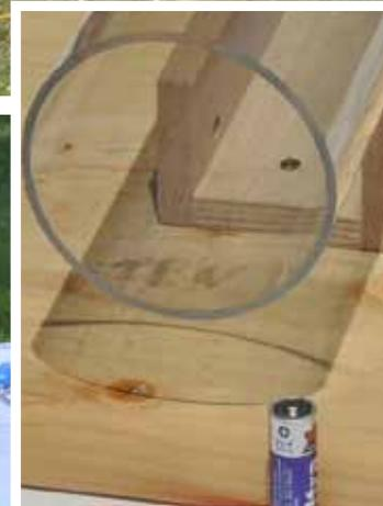
Bei einem 500 mm langen Quarzrohr findet man eine „Kugelschale“ mit 5,5 m Radius (blaue Schnur), „Trennwände“ sowie Gruppen von kissenförmigen Strukturen. Regt man das Rohr an, z.B. mit einer Induktionsschleife, Monozelle oder einem Mobiltelefon, so verändern sich die „Kissen“.
