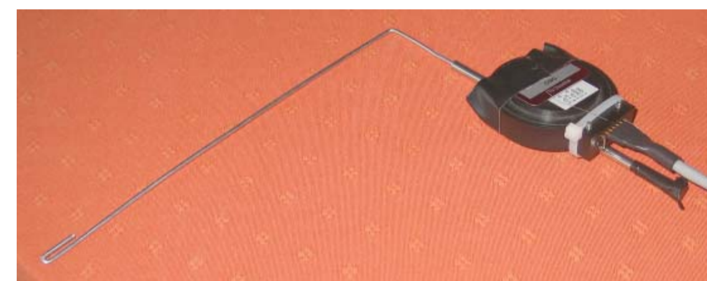
Werkzeug: die L-Rute aus Aluminiumdraht steckt lose in einem elektronischer Winkelgeber, der die Neigung der Hand beim Rutengehen ermittelt.
