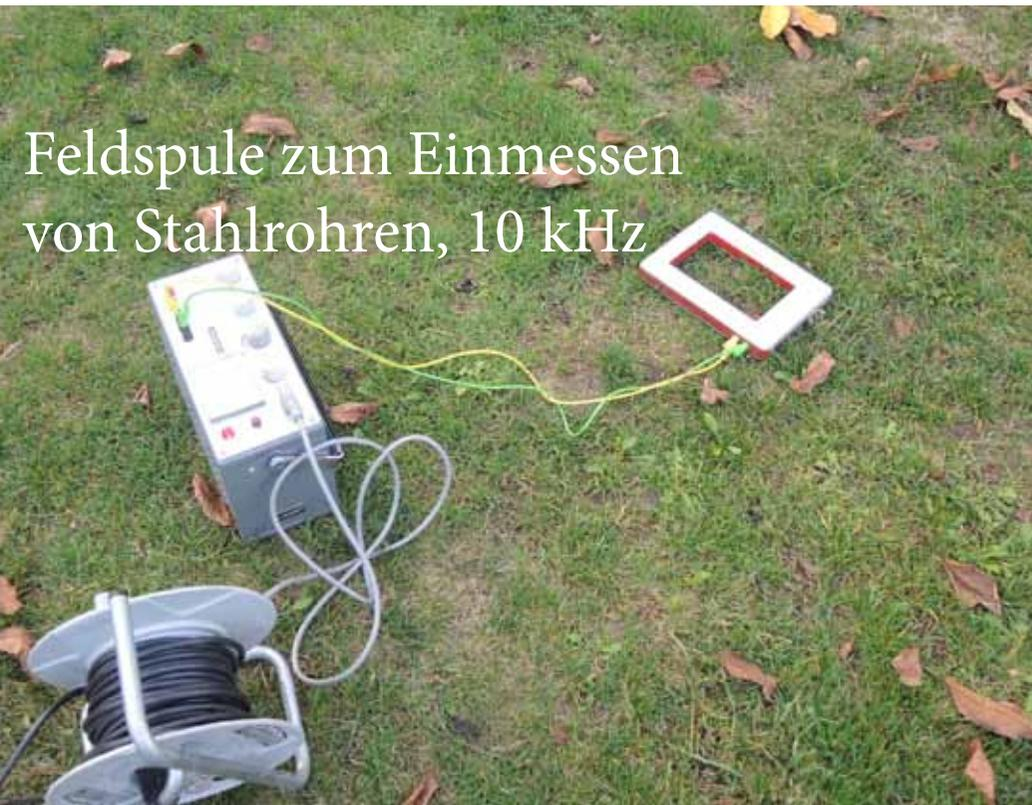
Feldspule zum Einmessen von Stahlrohren, 10 kHz
