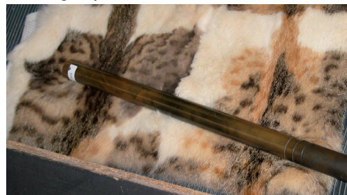
Abb. 02: Reibungselektrizität mit Katzenfell u. Kunststoff-Stab (Kunstharz), Aufladung negativ (Harzelektrizität)
