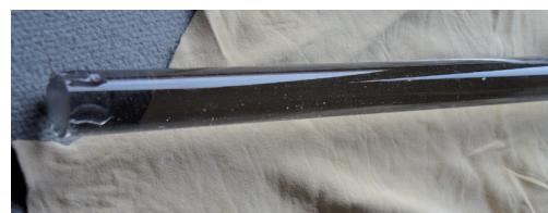
Abb. 03: Reibungselektrizität mit Ledertuch und Glas-Stab, Aufladung positiv (Glaselektrizität)
