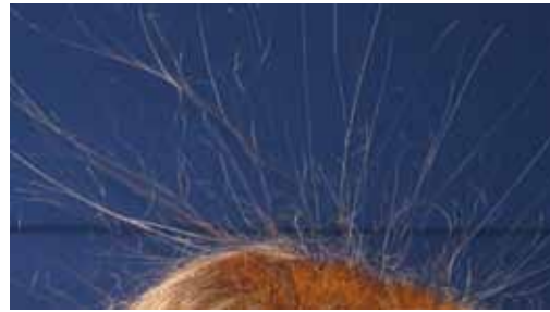
Abb. 05: Eine Person stellt sich auf ein gegen den Boden elektrisch isolierten Podest. Anschließend wird sie mit Hochspannung aufgeladen. Die Haare stellen sich hoch. Beobachtung: je höher die Ladespannung, umso größer der Effekt.
