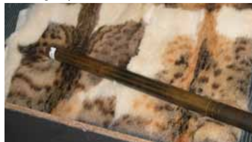
Abb. 02: Reibungselektrizität mit Katzenfell u. Kunststoff-Stab (Kunstharz), Aufladung negativ (Harzelektrizität)
