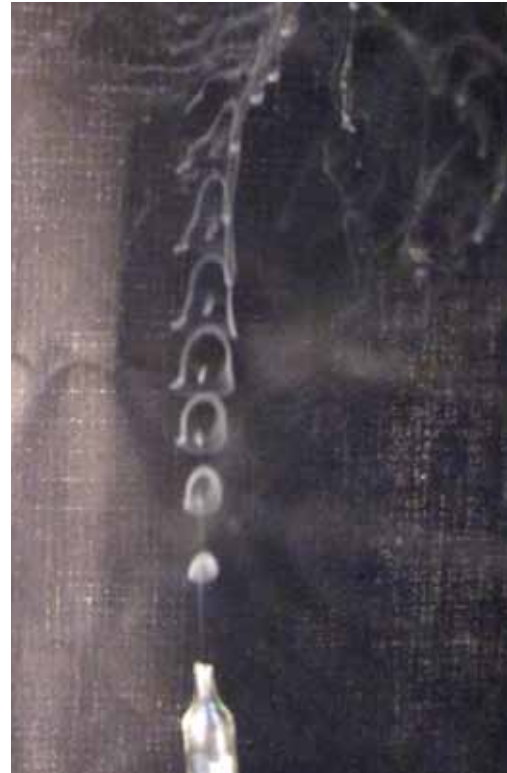
Abb. 28: Ähnliche Strukturen wurden mit einem periodisch angeblasenen Rauchröhrchen hergestellt. Normalerweise wird es zur Detektion von Luftströmungen verwendet.
