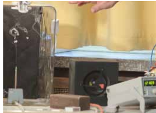
Abb. 29: Das Rauchröhrchen (links) wurde über einen Schlauch von einer schwingenden Lautsprechermembrane (Mitte) periodisch angeblasen. Die Frequenz war einstellbar.
