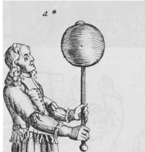
Abb. 01: Geladene Schwefelkugel, Otto v. Guericke, 1672, Vogelfeder (a) wird abgestoßen. (/Teichmann 1996/)
