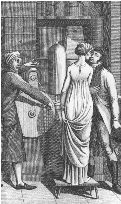
Abb. 04: Elektrischer Kuss, um 1750, links: Reibungselektriermaschine, die Dame steht auf einem isolierten Schemel. /Teichmann 1996/
