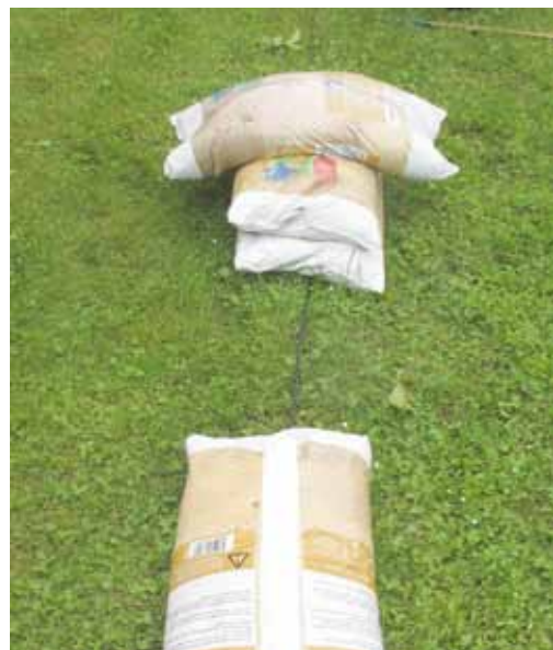
Abb. 22: Schwarzer Wasserschlauch unter Sandsäcken, sie sollen Erdreich mit einstellbarer Überdeckung simulieren.
