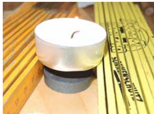
Abb. 38: Kerze mit etwas Abstand brennt über einem Permanentmagnet. Nur kurzzeitig betreiben!
