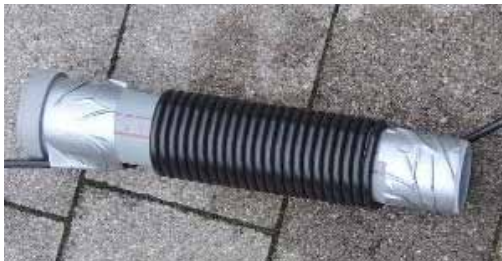
Abb. 15: Dünner Wasserschlauch ist als Spule auf ein Abwasserrohr gewickelt kuehlwasser-vier-05.htm
