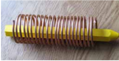
Abb. 55: Abisolierter Kupferdraht wurde zu einer Spule gewickelt. Im Inneren steckt eine Ölkreide.
