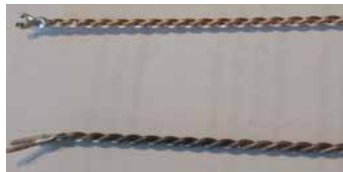
Abb. 53: oben: Zwei Kupferdrähte (Querschnitt 1,5 \text{ mm}^2 ) nach einer Behandlung mit Schraubstock und Akkuschrauber. Sie sind verdrillt und an deren Enden weich verlötet. Das Material ist stark verformt.
