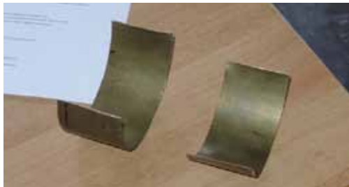
Abb. 58: Ein Messingrohr wurde in zwei Teile gesägt. Nach dem Auftrennen hat es sich geweitet. Offensichtlich stand es noch unter mechanischer Spannung durch den Ziehvorgang bei der Herstellung. strom-sehen-011.htm#kapitel-11
