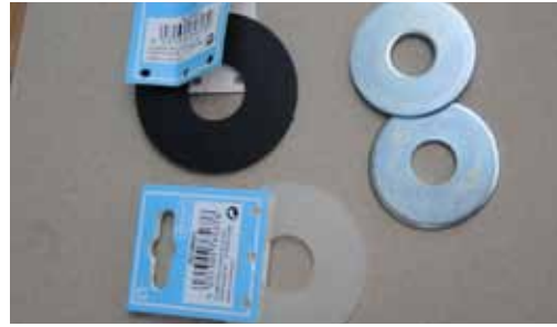
Abb. 48: Unterlegscheiben aus verzinktem Eisen, Gummidichtung, Silikondichtung (Teile aus dem Baumarkt)
