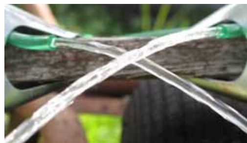
Abb. 08 und Abb. 09: Zwei Wasserstrahlen kreuzen sich windschief. Luft wird vom Wasserstrahl mitgenommen. Am Kreuzungspunkt entstehen nicht nur in der Luft Wirbel. bbewegte-materie.htm#kapitel-03-03
