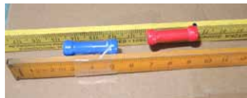
Abb. 31: Jeder Magnet ist zum besseren Verschieben auf einen Meterstab geklebt. Damit lassen sie sich auch mit gleichnamigen Polen zwangsweise aneinander bringen.
