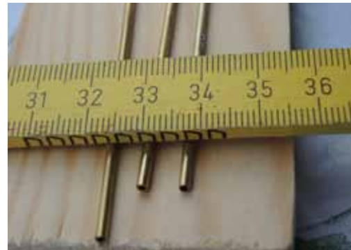
Abb. 21: dünne Messingrohre aus dem Baumarkt (1mm Bohrung)
