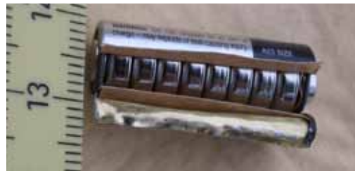
Abb. 34: Diese A23-Batterie für 12 Volt besteht aus acht hintereinander geschalteten Knopfzellen ( 8 \cdot 1,5 \text{ V} = 12 \text{ V} ). batterien.htm
