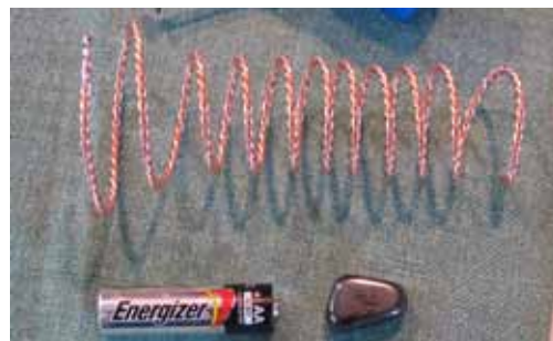
Abb. 54: Der verdrillte Kupferdraht wurde um den Hals einer Weinflasche gebogen. Wenn man eine Monozelle oder einen Permanentmagneten durch seine Längsachse bewegt (z.B. fallen lässt), ändern sich die spürbaren Eigenschaften dieser Spule. kuehlwasser-zwanzig.htm#kapitel-02-03
