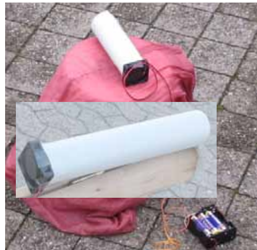
Abb. 40: Ein kleiner Computerventilator liegt und bläst in ein Rohr aus dickem Papier. Statt der Betriebsspannung von 12 V wird er aus drei Monozellen mit nur 4,5 V versorgt. eenergiesparlampe-gewendelt.htm#kapitel-06 kuehlwasser-zwanzig.htm#kapitel-01-03
