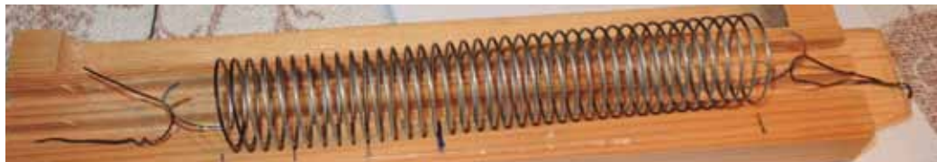
Abb. 59: Spiralfeder in einer verstellbaren Halterung. Die Länge und damit die Zugkraft sind einstellbar.
