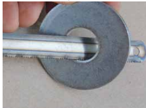
Abb. 51: Das Metallsägeblatt wird durch einen Ringmagneten aus Ferrit gezogen.
