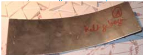
Abb. 57: Aluminiumblech kalt gebogen.
