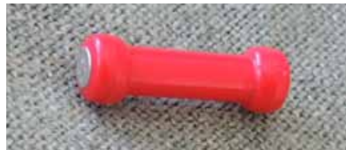
Abb. 30: Magnet von einem Spielzeug. In diesem Kunststoffkörper befindet sich an den Stirnseiten jeweils ein kleiner Neodym-Magnet.
