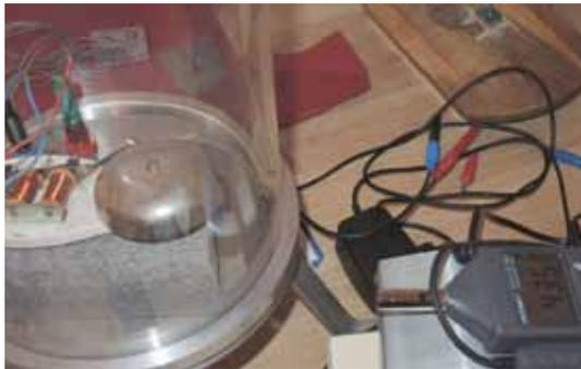
Abb. 26: (links) elektrische Haustürklingel unter einer Vakuumglocke. Rechts daneben liegt ein Schallmeßgerät.
