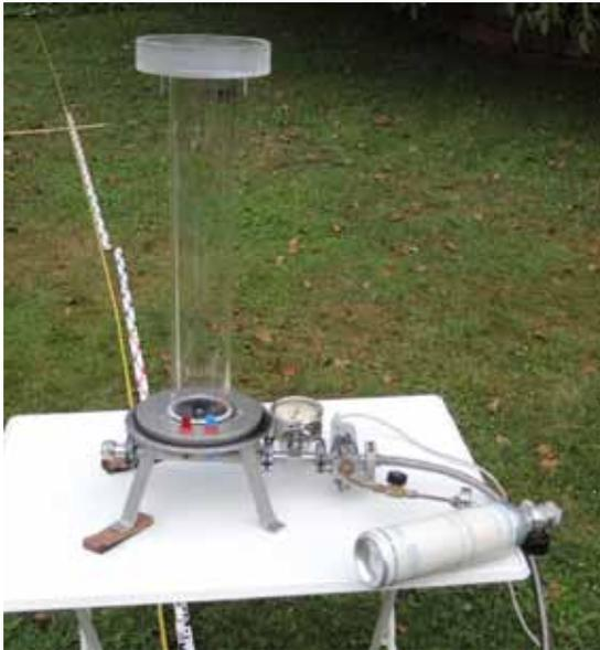
Abb. 30: Das Quarzrohr ist oben und unten luftdicht verschlossen. Es lässt sich evakuieren und über eine Füllereinrichtung wieder mit Gas füllen (im Bild eine Neonflasche).
