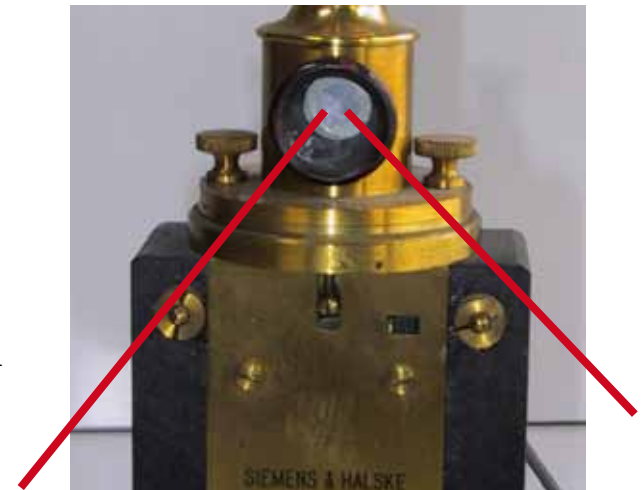
Galvanometer mit Drehspiegel (Siemens & Halske)
