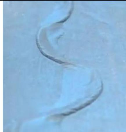
Abbildung 2: Mäandrierender Wasserstrahl auf einer senkrechten Glasscheibe.
