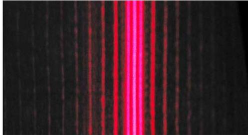
**Beugungsbild** eines Spaltes mit rotem Laserlicht: Die Intensität nimmt nach außen hin ab. Der Abstand der Linien erscheint in der Mitte kleiner: dort tritt ein zusätzliches Maximum auf. Das Beugungsmuster ist spiegelsymmetrisch.
