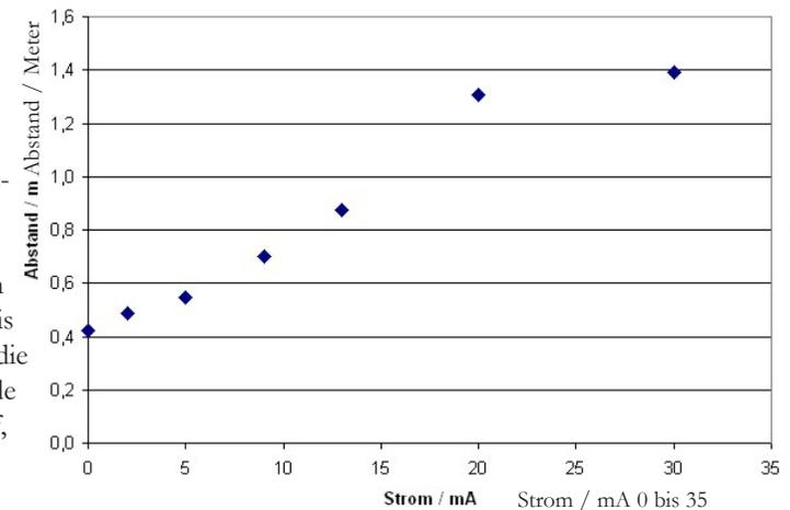
Die Position der Marken wurde auf eine gerade Linie parallel zur Gebäudewand projiziert und ausgemessen. Erhöht man nun den Strom schrittweise bis zu 30 mA und trägt die gemessenen Abstände gegen den Strom auf, so ergibt sich dieser Zusammenhang.
