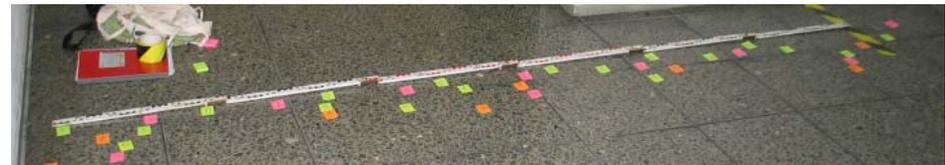
Der Schacht mit den Rohren befindet sich hinter der roten Tür (Bildmitte). Das feine Muster wurde zunächst mit gelben Papiermarken auf dem Boden gekennzeichnet. Nach dem Einschalten eines kleinen Gleichstroms von einigen Milliampère im Kabel, vergrößert sich der Abstand der spürbaren Positionen (Markierungen mit anderen Farben). Die Aufweitung des Musters hängt von der Höhe des Stromes ab.
