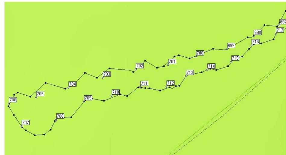
Verfolgen einer Kante, GPS-Datenaufnahme per Knopfdruck, offene Kreise mit Nummer = gefundene Position der Kante, schwarze Punkte mit Verbindungslinie = beim Suchen gelaufener Weg (automatische Datenaufnahme).
