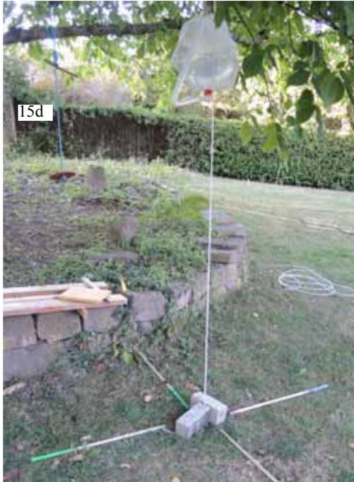
Abb. 15d: Durch einen Schlauch mit 1 mm Innendurchmesser fließt Wasser senkrecht nach unten. Bei dieser Anordnung läßt sich beobachten, daß durch die Schlauchachse vier Halbebenen (markiert mit Holzstäben) gehen, die sich langsam gegen den Uhrzeigersinn um die Schlauchachse drehen. Die Zeit für eine Umdrehung liegt im Bereich von Minuten.
