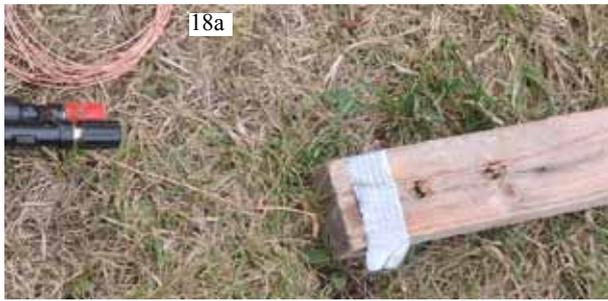
Abb. 18: Ein 0,6 mm dicker Kupferdraht liegt auf einer Holzlatte in Nord-Südrichtung.
