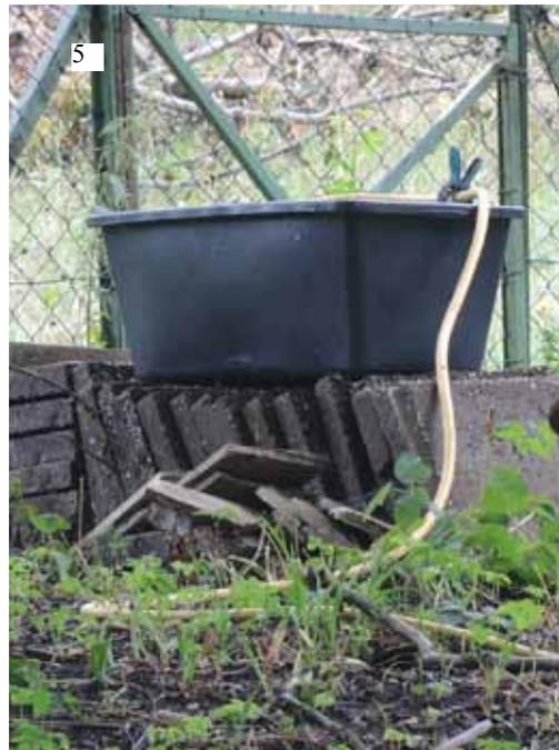
Abb. 5: Ein kleiner Hochbehälter reicht für die Versuche aus. Nach Ansaugen am Schlauch fließt das Wasser von alleine heraus. Bei den geringen Abnahmen im Bereich von Litern pro Minute hält der Wasservorrat lange.
