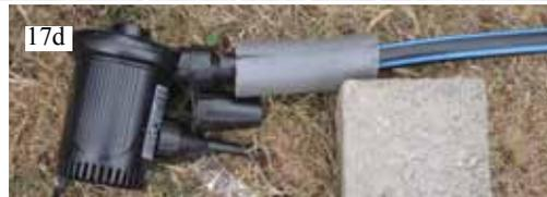
17d: Gebläse zum Aufpumpen von Luftmatratzen mit vorgeschalteter Elektronik zum Einstellen der Drehzahl.
