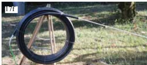
Abb. 17f und 17g: Spule aus 20 mm HD-PE-Rohr, links mit fließendem Wasser, rechts mit Luftströmung.
